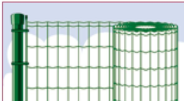
**B** Připevněte napínací objímky k napínacímu sloupku každých 40-50 cm. Připevněte napínací tyč ke třetímu oku sítě počítaje od jejího okraje dvojím zapletením vázacího drátu. Konec drátu připevněte k napínací objímce (nebo napínáku). Poté postupně napínejte síť dotahováním šroubů jednotlivých objímek (nebo napínáků) až bude síť správně napnutá a napínací drát se bude nacházet co nejbližně napínacího sloupku. Zahákněte horní drát o šroub přičítky a zaražte přičítku do otvoru ve sloupku.
